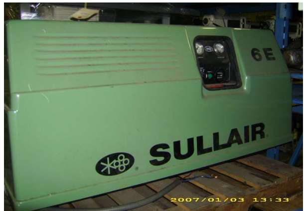
SULLAIR 6E, 5 HP AIR COMPRESSOR, 220V-3PH
